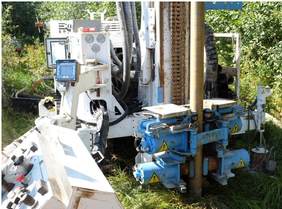
Foto 1.5.2. Puurmasina juhtseadmed ja välimine puurtoru.
